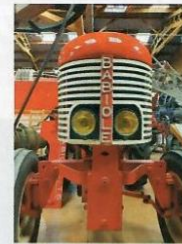
Ce T6 a été fabriqué en 1951 par les établissements Lucien Babiole. Conçu sur base de chenillette NSU Kettenrad, il est mû par un 4-cylindres de Peugeot 203.
